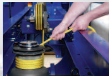
Reißprüfung Kontinuierliche Kontrolle für Qualitäts-Leinen
